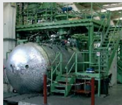
Заливка смолы в глубоком вакууме
